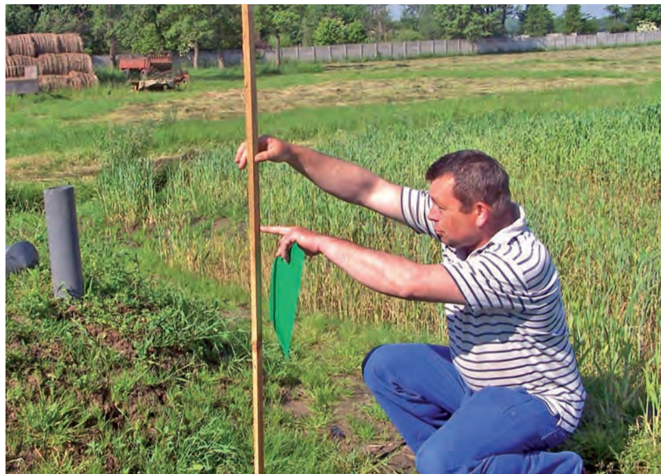
Stanisław Przybysz pokazuje poziom wody, jaki utrzymuje się, a nie powinien, w instalacji poletka odsączającego.
