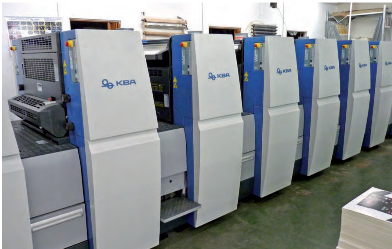
Nowa maszyna offsetowa drukuje w 1 procesie technologicznym w 5 kolorach i lakieruje papier.
