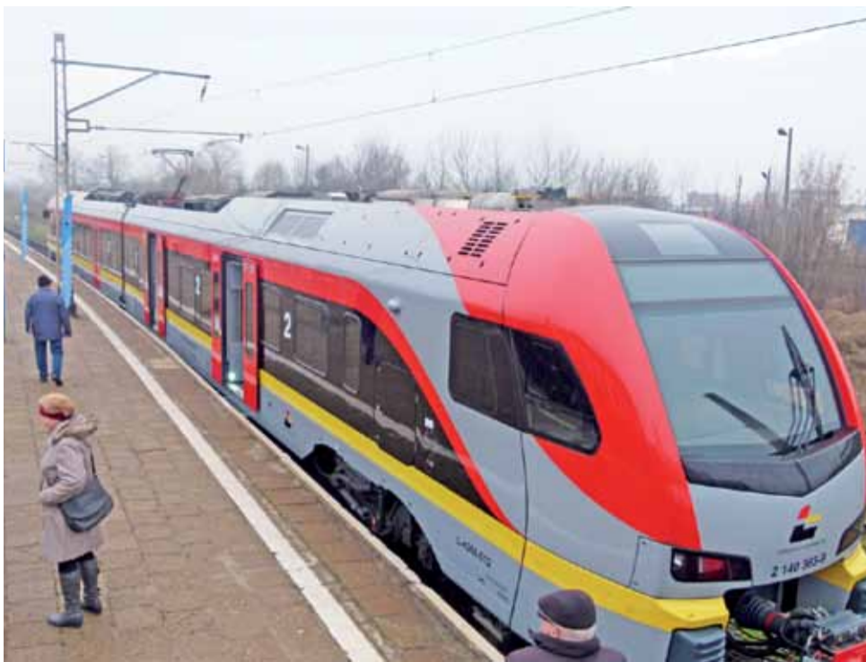
Pociąg Stadler Flirt 3 na łowickim peronie. Może zabrać 120 osób na miejscach siedzących.
