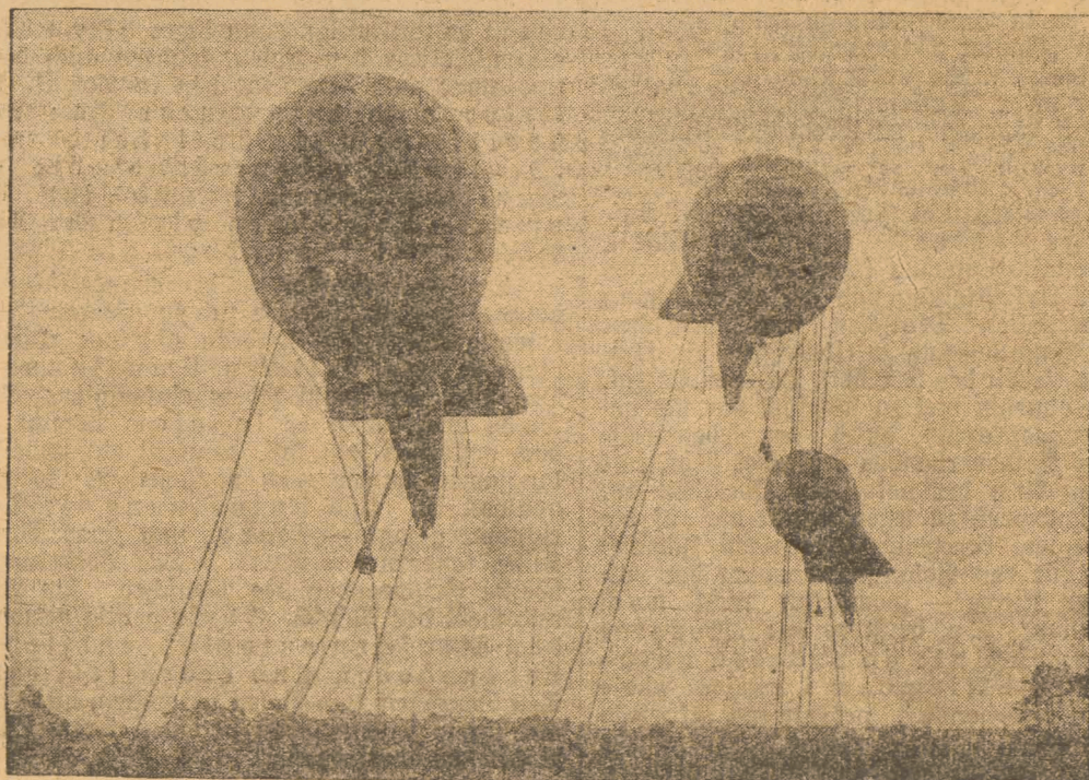
Deutsche Ballon-Sperren zum Schutz gegen feindliche Fliegerangriffe Besuch bei der Luftsperrbatterie in Bad Saarow. — Eine Ballongruppe in der Luft.
