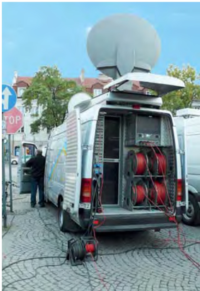
Serce łowickich Faktów: wóz transmisyjny z nadajnikiem satelitarnym.
