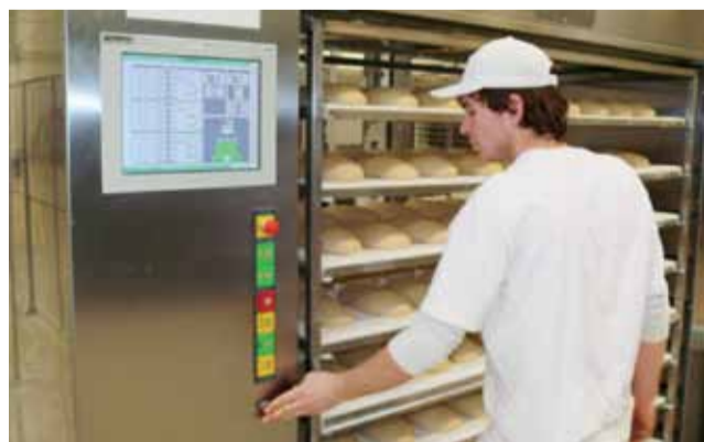
Wystarczy wcisnąć guzik i podajnik automatycznie odbiera uformowane z ciasta bochny z regatów, by wprowadzić je do pieca, sięgającego niemal pod sufit hali mieszczącej piekarnię.
