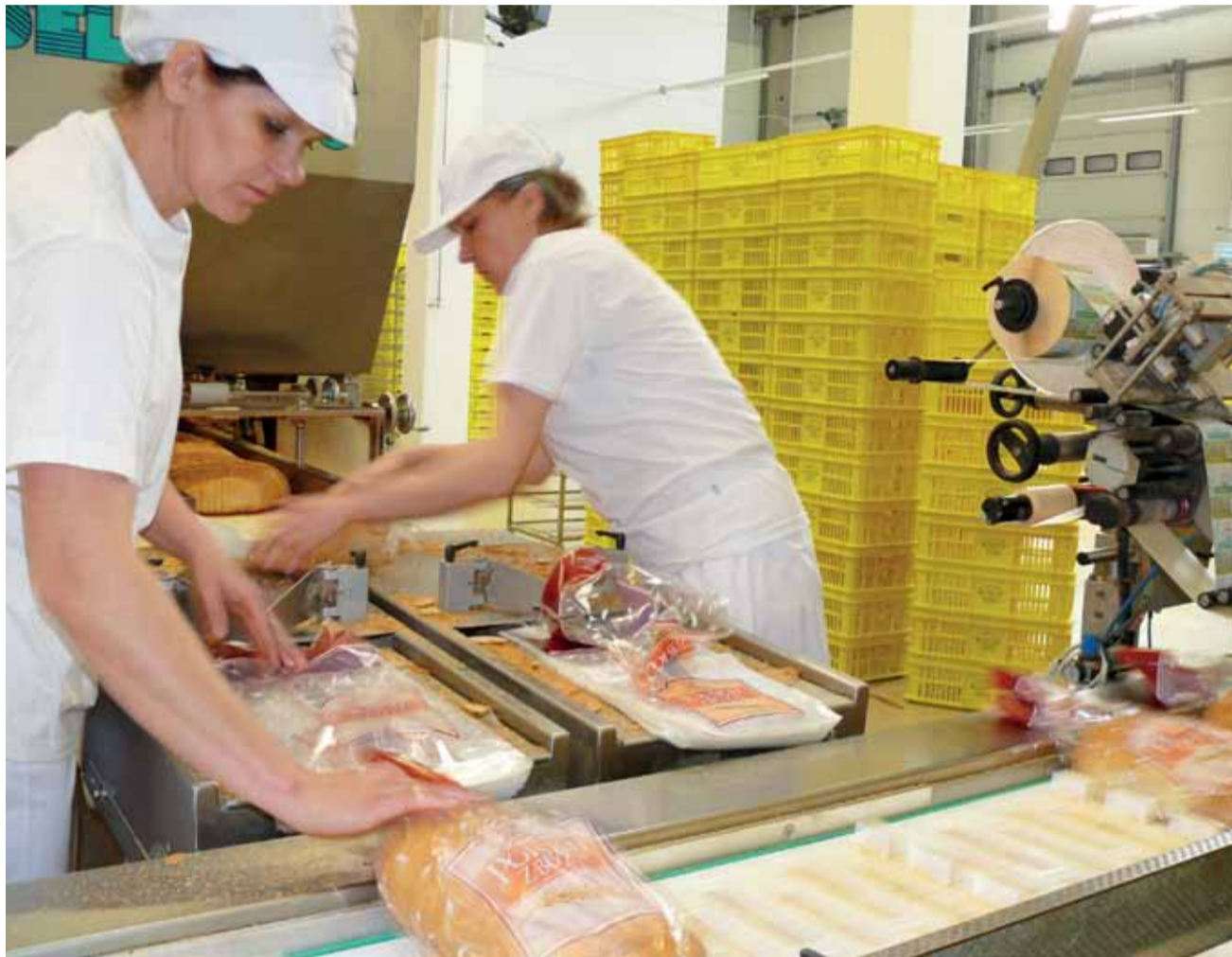
Pracownicy Marel przy obsłudze kralajnicy, gdzie pokrojone pieczywo jest pakowane w plastikowe torby. Kralajnica może w ciągu godziny pokroić 2,4 tys. chlebów.
