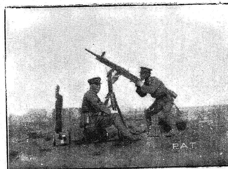
Na zdjęciu naszym widzimy karabin maszynowy specjalnej konstrukcji, używany przez Japończyków w czasie ostatnich walk z chińczykami do ostrzeliwania samolotów z ziemi.
