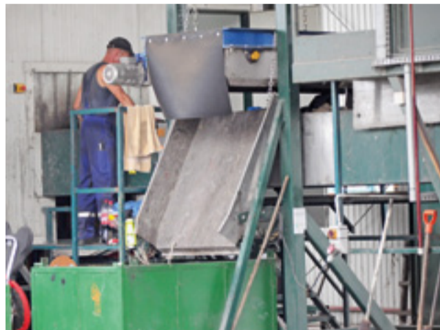
Linia do sortowania śmieci na wysypisku w Jastrzębi jest częściowo automatyczna (np. elektromagnes wyłapuje metale), ale musi być też obsługiwana ręcznie przez pracowników.
