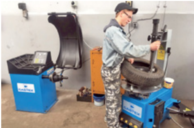
Urządzenia do naprawy i wyważania kół w pracowni samochodowej już są wykorzystywane.
