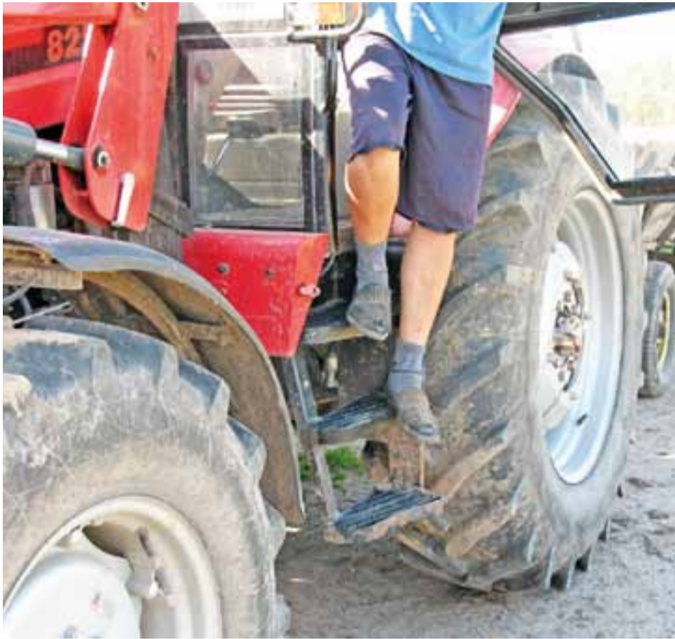
Zdjęcie przedstawiające nieprawidłowy sposób schodzenia z ciągnika (rolnik powinien schodzić przodem do stopni) oraz nieprawidłowe obuwie robocze.
