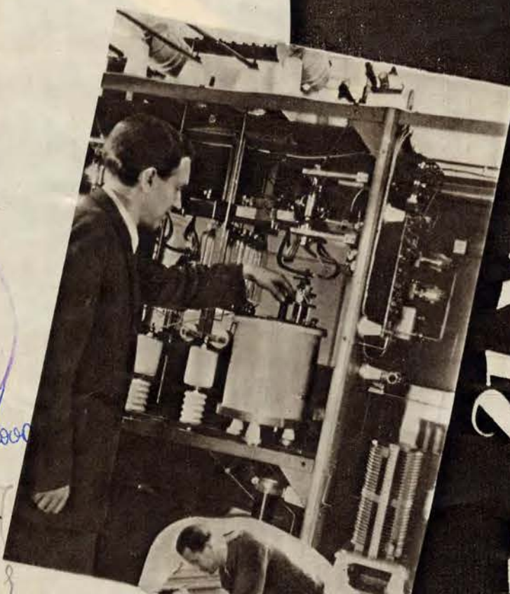
Gmach odbudowanej Radiostacji Łódzkiej. Niżej: inż. Klimaszewski przy stopniu końcowym wzmacniacza mocy nadajnika. Obok: stopień końcowy wzmacniacza mocy nadajnika.
