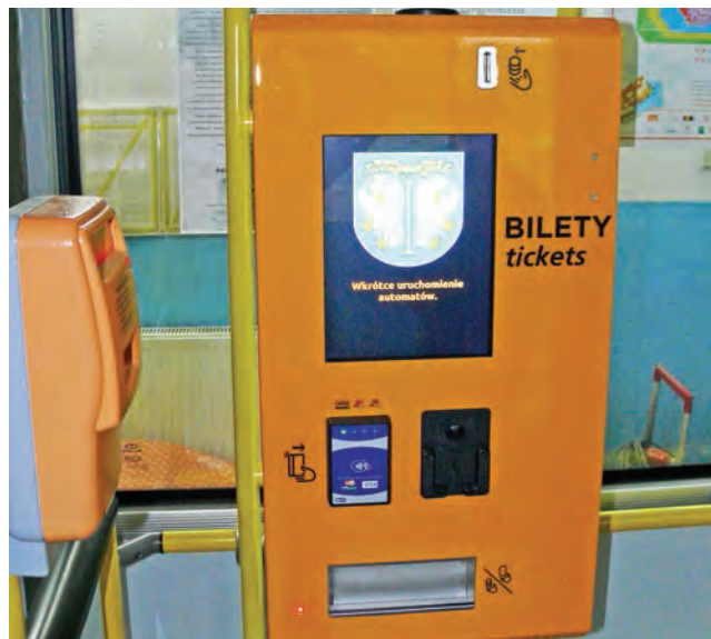
Mobilne biletomaty są już zamontowane w miejskich autobusach, mają duży czytelny wyświetlacz i miejsce do wrzucenia bilonu oraz czytniki kart bankomatowych i Łowickiej Karty Miejskiej (poniżej wyświetlacza).
