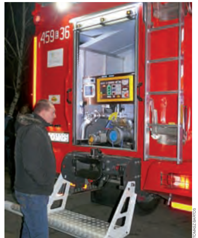
Wiele osób z uwagą oglądało nowy samochód, m.in. panel sterowania pompą podającą wodę ze zbiornika, w który jest on wyposażony.
