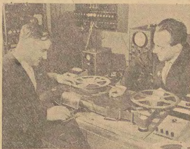
Grupa inżynierów łódzkich skonstruowała komplet aparatu- ry do rejestracji obrazu telewizyjnego na taśmie magneto- fonowej. Na zdjęciu: główny konstruktor Wł. Parchomienko (z lewej) i inż. A. Spirin sprawdzają aparaturę przed rozpoczę- ciem prób.
