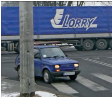
Pojedynczy słup został odsunięty od jezdni.
