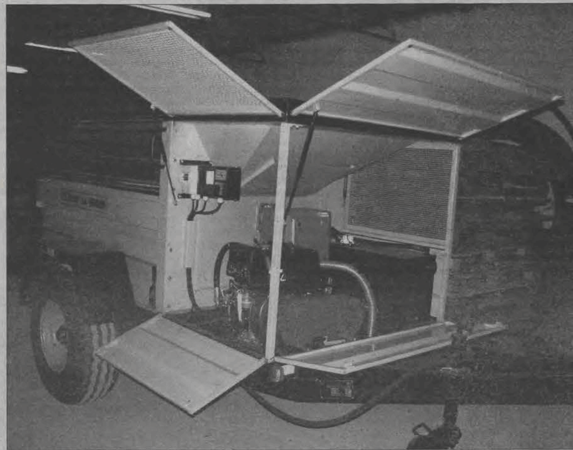
Recykler - urządzenie warte ponad 60 tys. zł ma pomóc łowickiemu Zakładowi Usług Komunalnych szybciej i taniej łątać dziury w miejskich ulicach.
