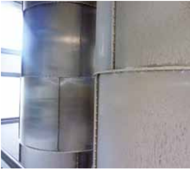
Od lewej: silos szczelny, obok silos nieszczelny. Widać, że obudowa nieszczelnego silosa pokryta jest pokładami mąki (jest to jedna z wad konstrukcyjnych zbiorników).
