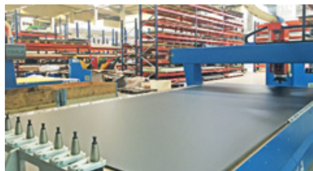
Maszyna CNC, służąca do precyzyjnego cięcia płyt HPL i HDPE, które są wykorzystywane do budowy urządzeń na place zabaw.
