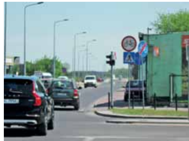
Zdjęcie nr 3. Łowicz, widok z ul. Broniewskiego na skrzyżowanie z ul. Sikorskiego i ul. Piłsudskiego. Za skrzyżowaniem „skupisko” zastłaniających się znaków drogowych.
