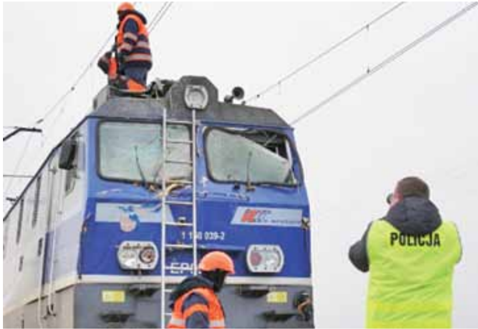
Kabinę lokomotywy uszkodziło powalone na szlak kolejowy drzewo.
