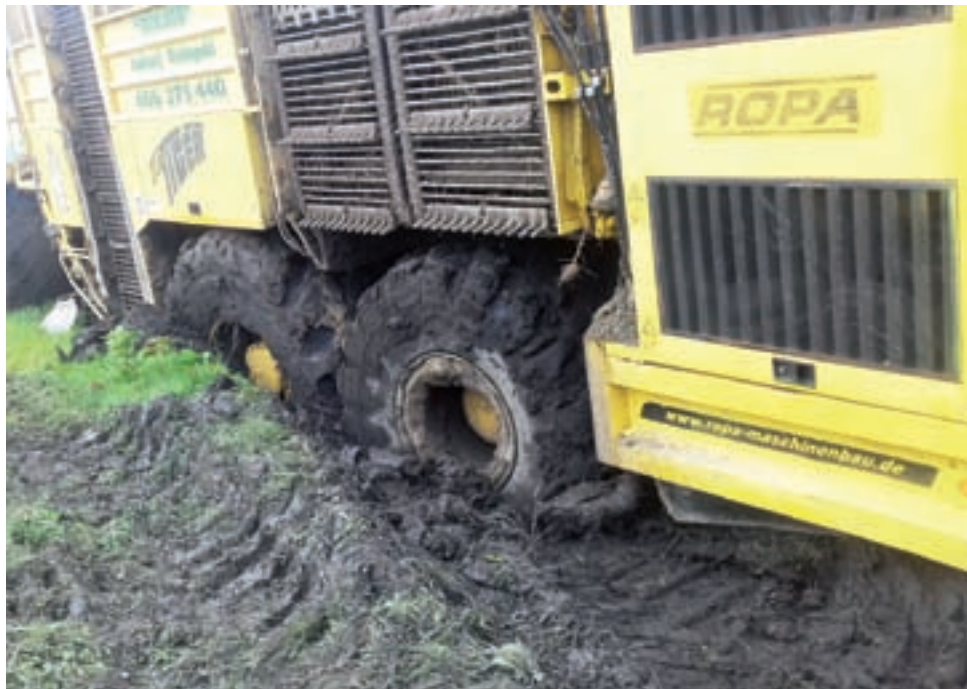
Kombajny do kopania buraków cukrowych topiły się na podmokłych polach w tym roku wielokrotnie. Wyciąganie kilkutonowych maszyn wymagało zaangażowania kilku ciągników, a nawet dźwigu.
